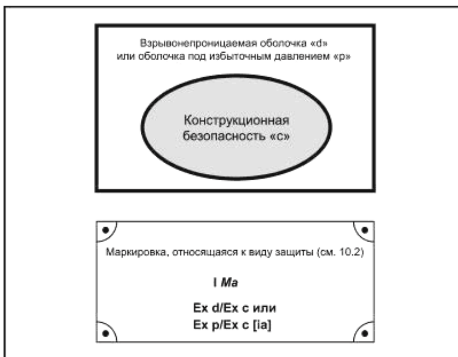
Рисунок 5 — Оборудование уровня взрывозащиты Ma (конструкционная безопасность «с» внутри взрывонепроницаемой оболочки «d» или оболочки под избыточным давлением «p»)
