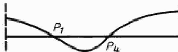
Рисунок 1 — Характерные собственные моды гибких роторов на податливых опорах
