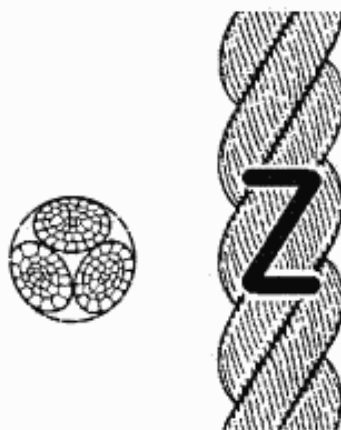
Рисунок 1 — Конфигурация 3-рядного крученого каната (тип А)
