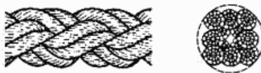
Рисунок 3 — Конфигурация 8-рядного плетеного каната (тип L)
