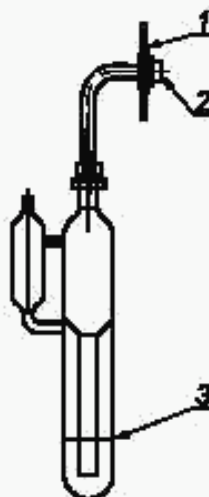
1 — панель; 2 — направление от НЕРА фильтра; 3 — уровень масла
