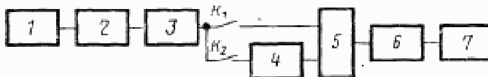
1—приемник; 2—формирователь; 3—дифференцирующая цепь; 4—инвертор; 5—схема совпадения; 6—ждущий мультивибратор с регулировкой длительности в зависимости от скорости; 7—осциллограф
