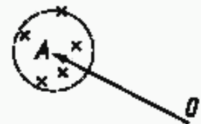
Рисунок 1 — Измерение вектора остаточного дисбаланса для случая случайной погрешности
