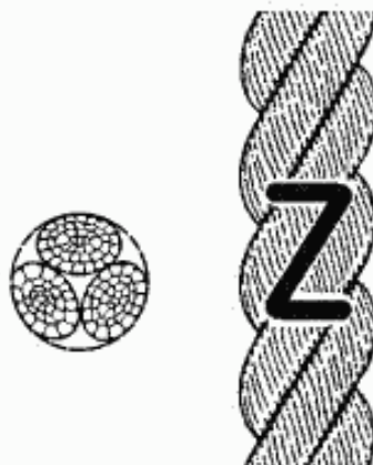
Рисунок 1— Конфигурация 3-рядного крученого каната (тип А)
