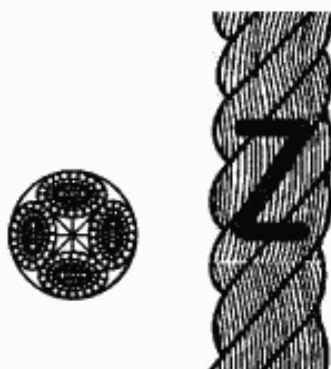
Рисунок 2 — Конфигурация 4-рядного крученого каната (тип В)
