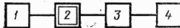
1—низкочастотный генератор сигналов; 2—передатчик (радиостанция в режиме передачи); 3—испытательная нагрузка; 4—измеритель девиации
