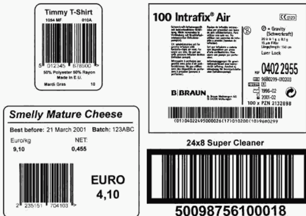
Рисунок 5 — Примеры этикеток с символом линейного штрихового кода и информацией для визуального чтения для идентификаторов применения AI (без учета масштаба)
