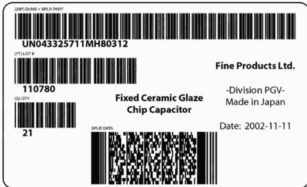
Рисунок 10 — Пример этикетки с символами линейного штрихового кода, символом PDF417 и информацией для визуального чтения для идентификаторов данных DI
