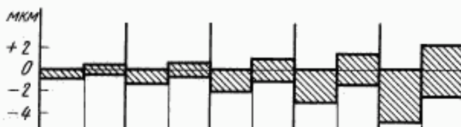
Поля допусков валов при номинальных размерах от 1 до 500 мм. Предельные отклонения
