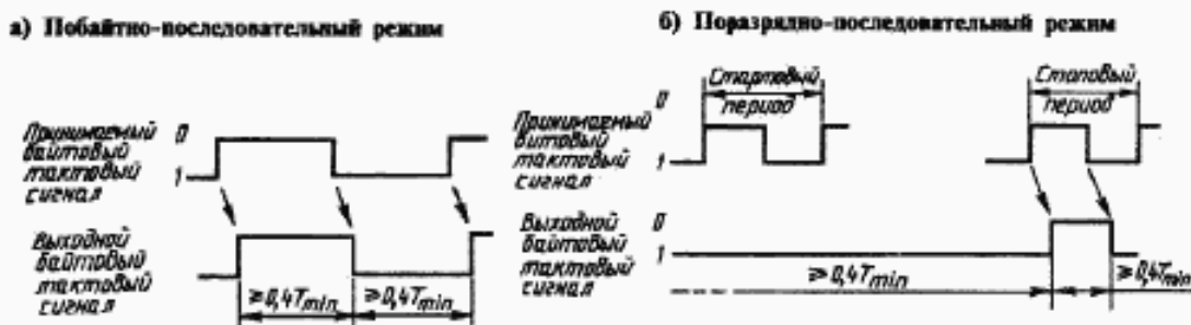
Соотношения между байтовыми тактовыми сигналами на соединителе и принимаемыми битовыми/байтовыми тактовыми сигналами
