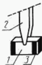
1 — корпус конденсатора; 2 — пинцет; 3 — покрытие торцевой поверхности
