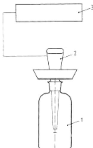
1 – экспериментальная емкость; 2 – кислородный электрод; 3 – прибор для измерения кислорода
