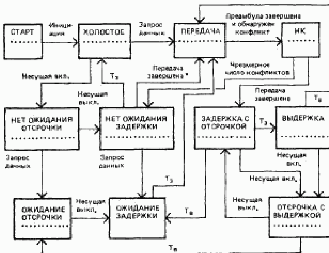
Диаграмма переходов состояний передающего компонента
