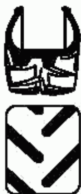
Рисунок протектора с грунтозацепами
