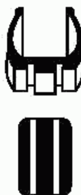
Рисунок протектора с кольцевыми ребрами
