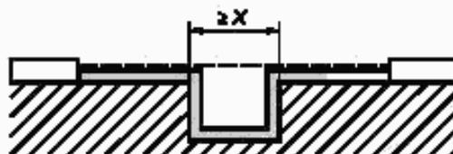
Условие: рассматриваемый путь охватывает желобок с параллельными боковыми стенками любой глубины шириной  $X$  мм или более.
