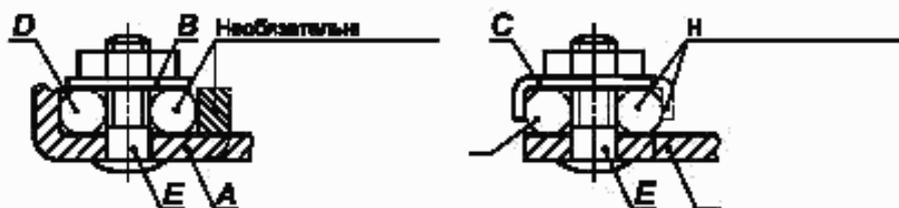
Примечание — Часть, удерживающая проводник на месте, может выполняться из изоляционного материала, если давление, необходимое для зажима проводника, не передается через этот изоляционный материал.
