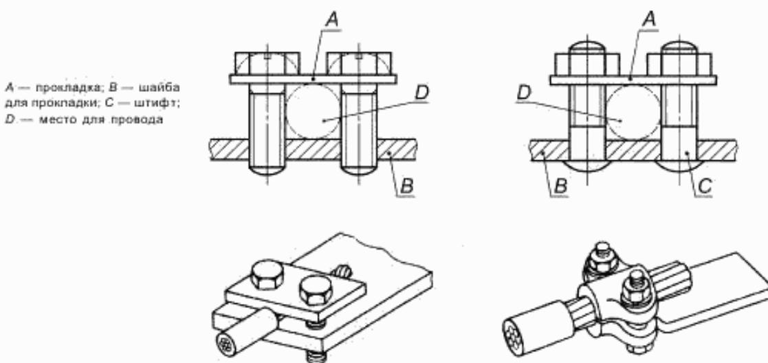
Примечание — Вывод с прокладками — резьбовой вывод, в котором проводник зажимается под прокладкой с помощью двух или нескольких винтов или гаек.
