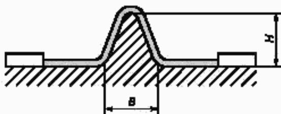
$H$  — минимальная высота ребра 2 мм;  $B$  — минимальная ширина основания, соответствующая требованиям к механической прочности
