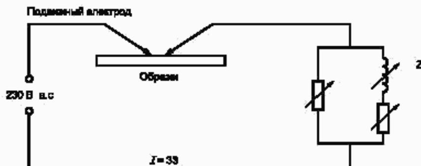
Рисунок М.2 — Схема испытания на воспламеняемость электрической дугой
