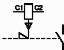
*Примечание* — Если в аппарате предусмотрено два независимых расцепителя (например, с разными номинальными параметрами), то выводы второго расцепителя обычно имеют маркировку C3, C4.
