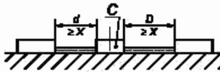
Воздушный зазор равен  $d + D$ .
