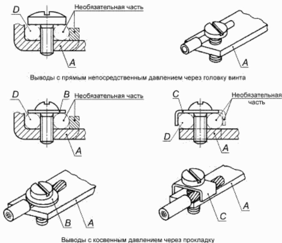
A — неподвижная часть; B — шайба или прокладка; C — устройство, препятствующее выскальзыванию проводника; D — место для проводника.
