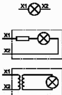
*Примечание* — Термин «Система сигнальных ламп» включает в себя также понятия встроенный резистор или трансформатор.
