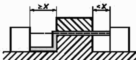
Условие: рассматриваемый путь охватывает не скрепленный стык с желобком шириной менее  $X$  мм с одной стороны и желобком шириной  $X$  мм и более с другой стороны.
