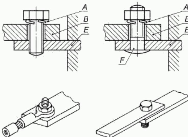
Примечание — Резьбовой или штифтовой вывод предназначен для зажима кабельного наконечника или шины с помощью винта или гайки.
