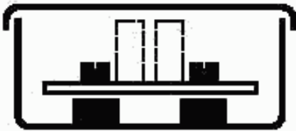
Рисунок В.3 — Коробка, обеспечивающая встроенность зажима или соединительного устройства
