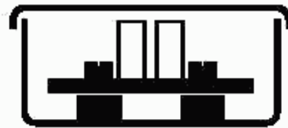
Рисунок В.2 — Коробка, составляющая единое целое с зажимом или с соединительным устройством
