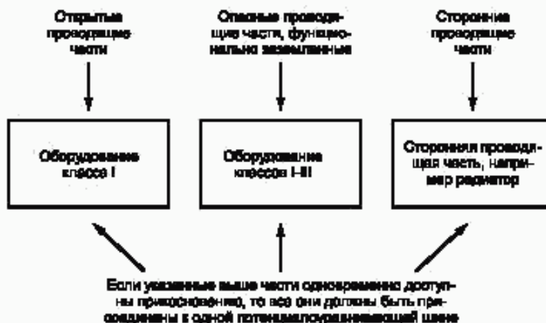
Рисунок 1 — Блок-схема уравнивания электрических потенциалов открытых, опасных и сторонних проводящих частей
