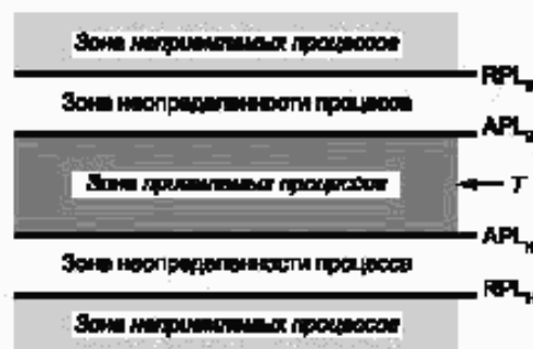
Рисунок 1 — Поле допуска: верхняя и нижняя линии APL и RPL в сопоставлении с зонами приемлемого, неприемлемого процессов и зоной неопределенности процесса
