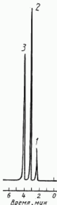
1 — сероводород; 2 — метилмеркаптан; 3 — этилмеркаптан
