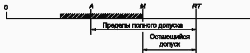
Рис. 5 — Принцип измерения декодируемости
