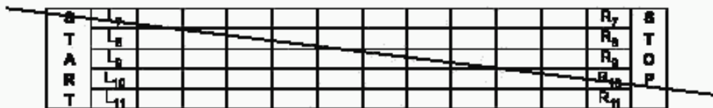
Рисунок К.2 — Схема, представляющая линию сканирования, пересекающую строки
