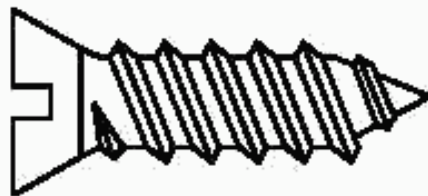
Рисунок 6 — Самонарезающий формирующий винт
