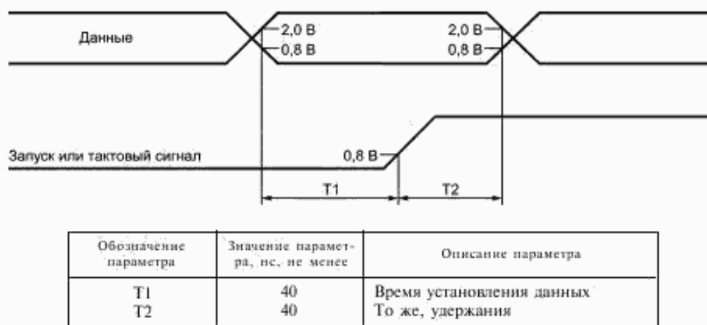
Рисунок В.6 — Передача данных по линиям TTLTRG* с синхронизацией по положительному перепаду тактового сигнала
