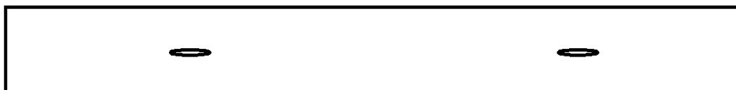
Пример 2 — две несплошности длиной по 6,4 мм
