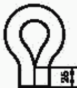
Рисунок 103 — Конфигурация шланга для испытания его холодом
