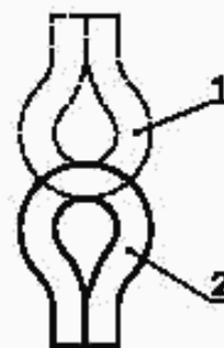
1 — промежуточное положение; 2 — положение шланга в начале и конце каждого изгиба
