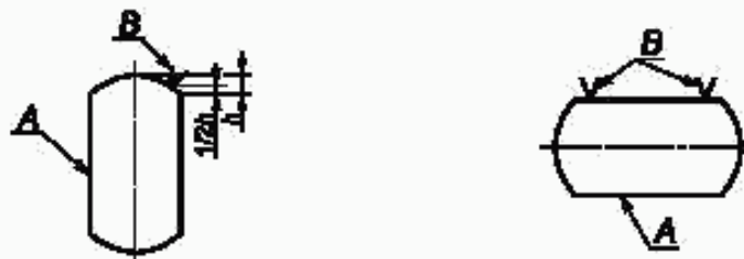
а — Положение термодпар для металлических баков
