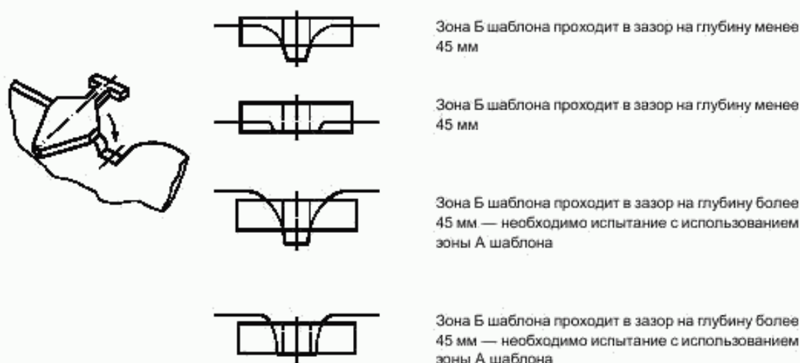
Рисунок Г.5 — Испытания V-образных зазоров с использованием зоны Б шаблона
