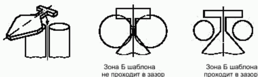
Рисунок Г.6 — Испытания прямоугольных зазоров с использованием зоны Б шаблона
