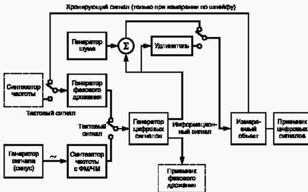
Рисунок 4.8 — Схема измерения фазового дрожания (метод по критерию увеличения K_D )
