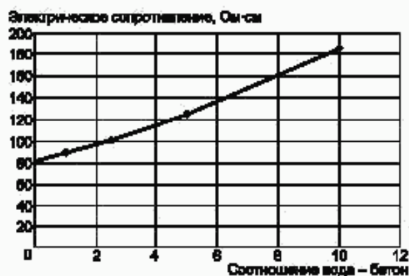
Рисунок 4 — Оценка электрического сопротивления водной вытяжки из бетона
