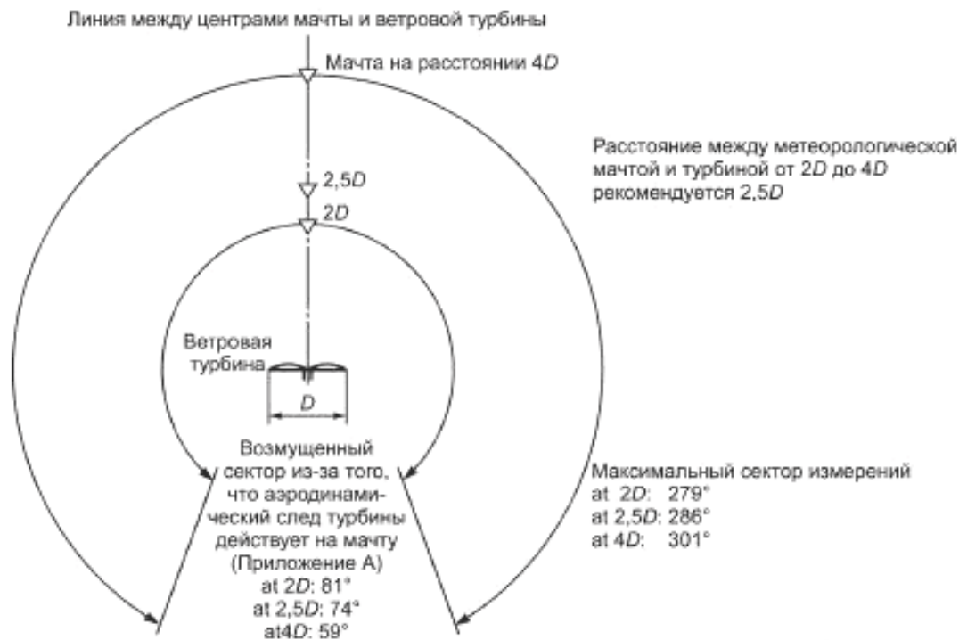
Рисунок 1 — Требования к расстоянию до метеорологической мачты и максимально допустимым секторам измерения
