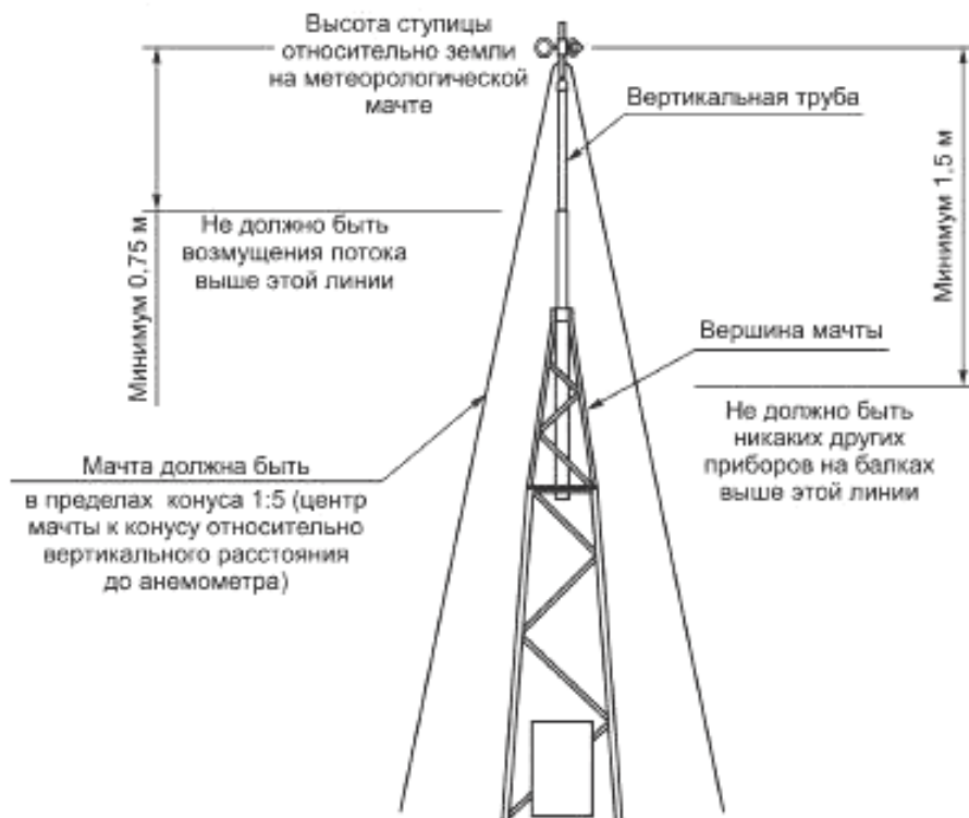
Рисунок G.1 — Пример установки анемометра в верхней части мачты и требования к монтажу
