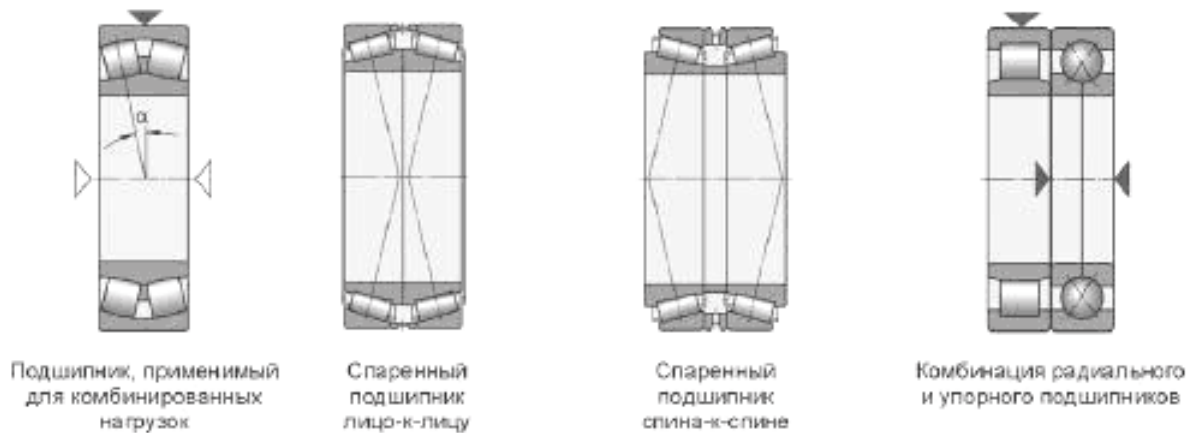
Рисунок 26 — Примеры расположений упорных подшипников
