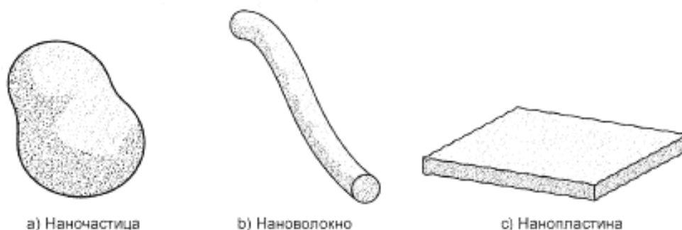
Рисунок 1 — Схематические изображения некоторых форм наночастиц
