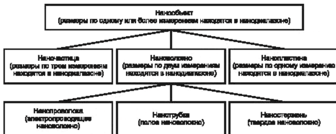
Рисунок 2 — Фрагмент терминологической иерархии нанобъектов
