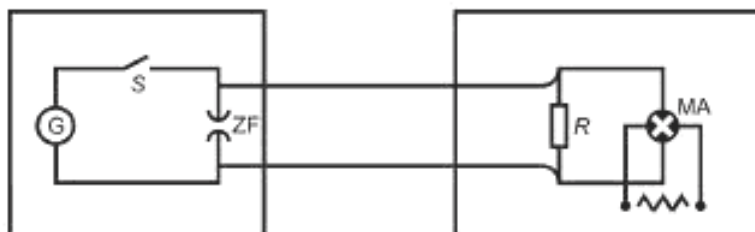
G — напряжение питания; R — измерительный резистор; S — переключатель; MA — прибор для измерения напряжения; ZF — искровой зазор
