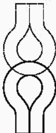
Рисунок 104 — Положения изгиба шланга после замораживания в камере
