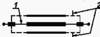
1 — центральный токоведущий проводник; 2 — круглый монтажный заземленный фланец
