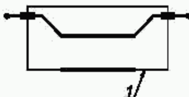
1 — заземленный металлический корпус
