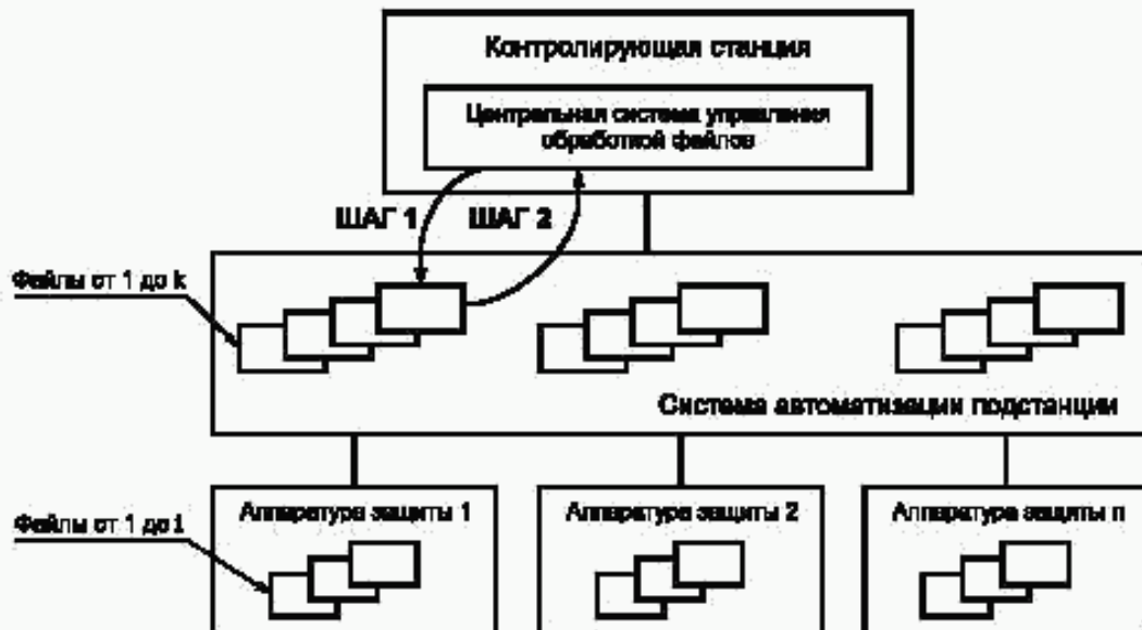
Рисунок 99 — Запрос от системы автоматизации подстанции
