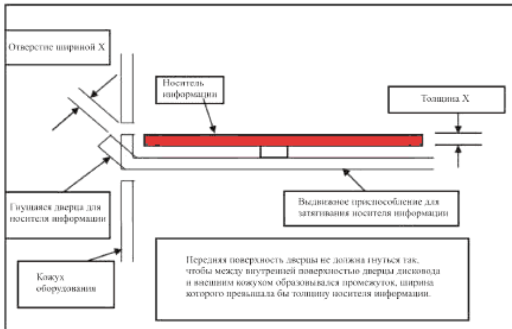
Р и с у н о к 48 – Пример определения ширины отверстия X в случае отсутствия отражателя
