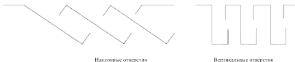
Р и с у н о к Р.1 – Примеры поперечного сечения отверстий, конструкция которых предотвращает попадание вертикально падающих предметов вовнутрь оборудования
