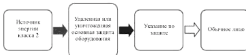
Р и с у н о к 11 – Модель защиты обычного лица от воздействия источника энергии класса 2 в процессе эксплуатации оборудования
