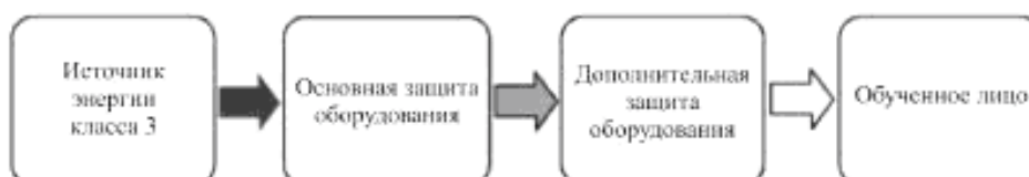
Р и с у н о к 15 – Модель защиты обученного лица от воздействия источника энергии класса 3
