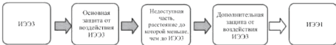
Р и с у н о к 28 – Модель защиты ИЭЭ1 от воздействия ИЭЭЗ
