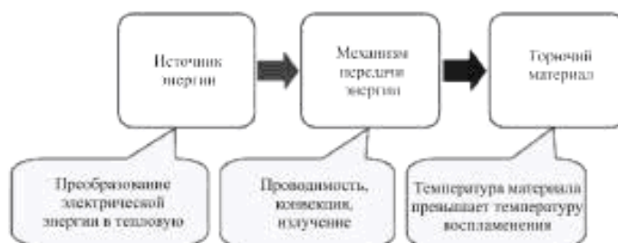
Р и с у н о к 5 – Модель возникновения возгорания при воздействии электричества
