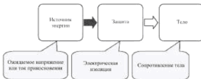
Р и с у н о к 4 – Модель защиты от боли или травм, вызываемых воздействием электричества
