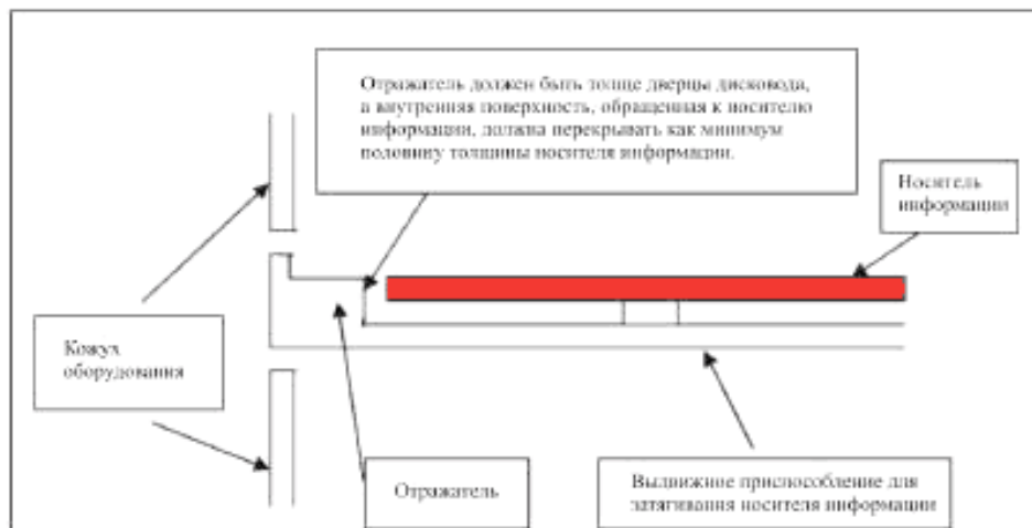
Р и с у н о к 49 – Пример определения ширины отверстия X при наличии отражателя
