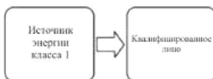
Р и с у н о к 16 – Модель защиты квалифицированного лица от воздействия источника энергии класса 1
