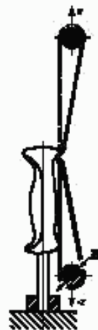
Рисунок 5 — Схема проведения испытания темляка
