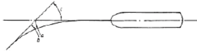
Рисунок С.2 - Определение угла остаточной деформации
