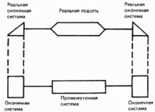
Рисунок 2 — Обмен данными между оконечными системами через промежуточную систему
