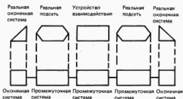
Рисунок 4 — Взаимосвязь реальных подсетей посредством отдельного устройства взаимодействия
