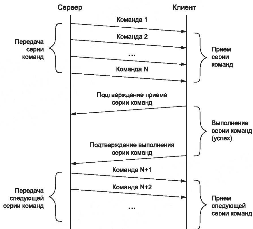
Рисунок 2 — Последовательность передачи данных (успешное выполнение роботом серии команд)
