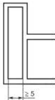
Рисунок F.1 — Полая камера в ПВХ профиле
