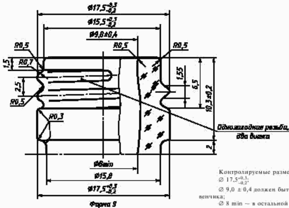
Рисунок 54 — Венчик типа В<sub>1</sub>-18
