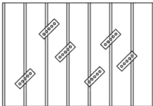
Рисунок Н.2 — Типичные положения ударной машины для напольных покрытий и легкого стандартного пола
