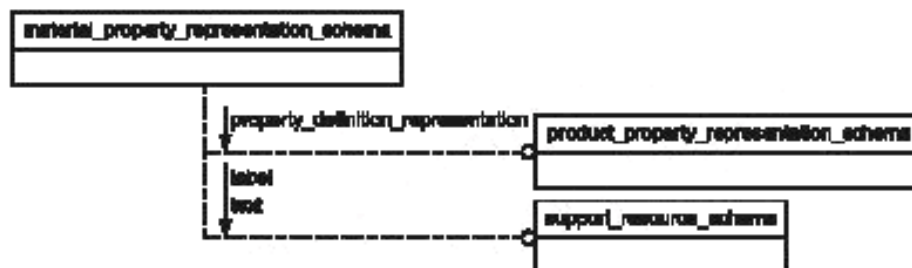
Рисунок D.3 — EXPRESS-G диаграмма схемы material_property_representation_schema (диаграмма 1 из 2)
