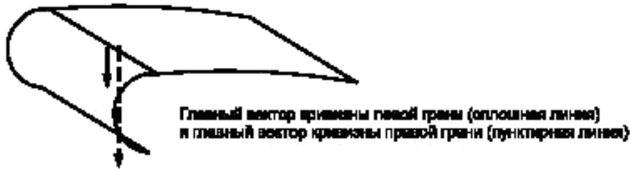
Рисунок 41 — Разрыв G2 вследствие разницы значений вектора кривизны
