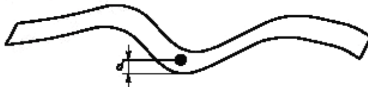
Рисунок 24 — Измерение полностью узкой грани
