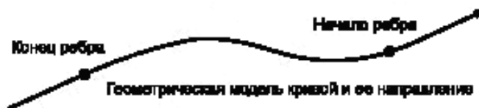
Рисунок 6 — Несогласованные направления ребра и кривой
