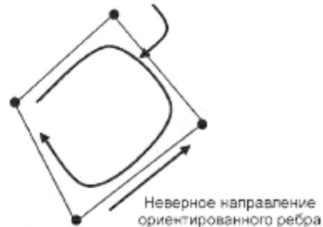
Рисунок 4 — Неверное направление ориентированного ребра
