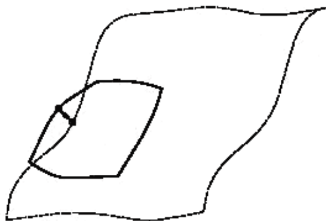
Рисунок 37 — Поверхностная грань с зазором между ее базовой поверхностью и граничным ребром
