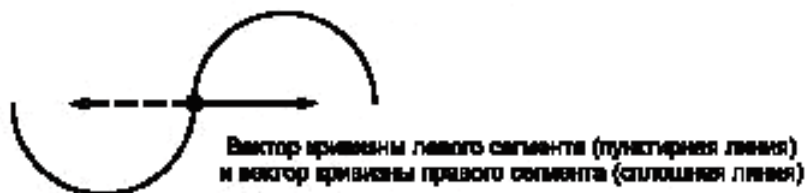
Рисунок 21 — Разрыв G_2 вследствие разных направлений радиусов кривизны
