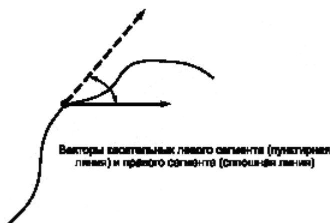
Рисунок 19 — Кривая, имеющая разрыв G1
