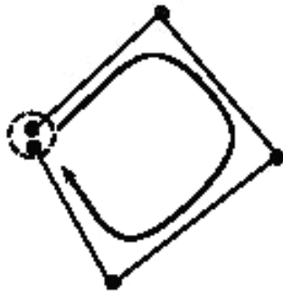
Рисунок 3 — Неполный контур ребер
