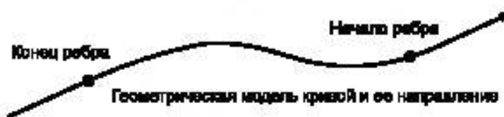
Рисунок 6 — Несогласованные направления ребра и кривой
