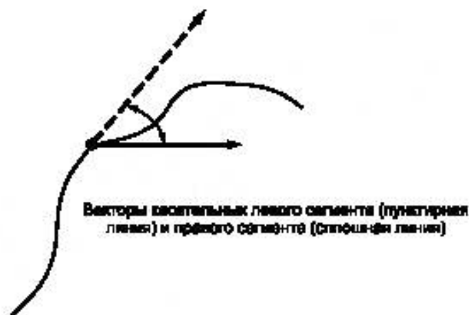
Рисунок 19 — Кривая, имеющая разрыв G1
