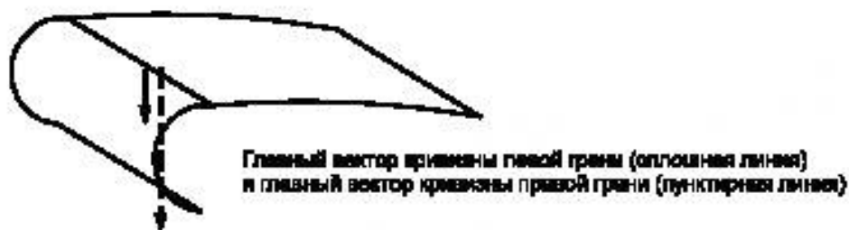
Рисунок 41 — Разрыв G2 вследствие разницы значений вектора кривизны
