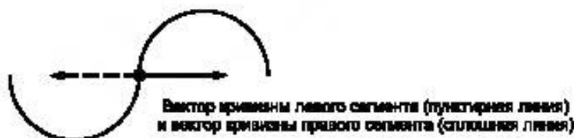
Рисунок 21 — Разрыв G2 вследствие разных направлений радиусов кривизны
