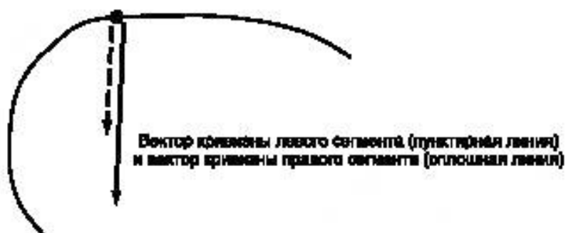
Рисунок 20 — Разрыв G2 вследствие различных значений радиусов кривизны
