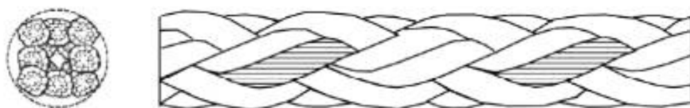
Рисунок 1 — Конфигурация 8-рядного плетеного каната (тип L)
