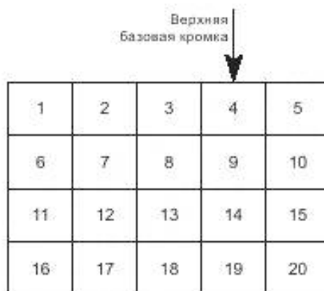
Рисунок 8 — Тестовые зоны PИСС при испытании на воздействие ESD
