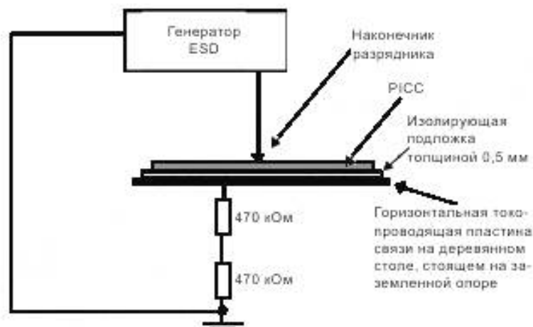
Рисунок 7 — Цепь испытания на воздействие ESD
