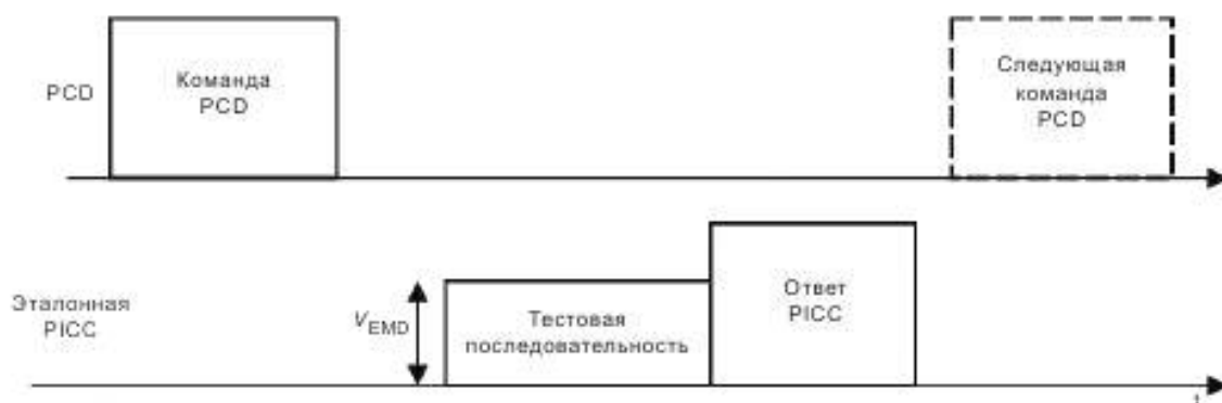
Рисунок Amd.2.1 — Испытание на устойчивость PCD (общее для типа A и типа B)
